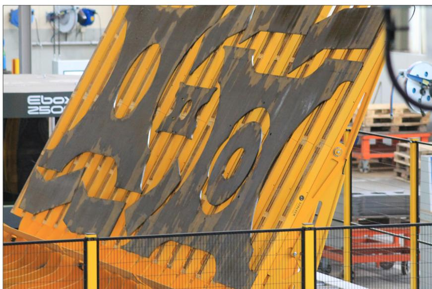
La panoplie, large de 2500 mm, est retournée grâce à un retourneur magnétique. Cet élément est un développement unique de haute technicité qui permet de prendre en charge une panoplie complète de pièces et de la déposer en miroir sur le convoyeur de la machine d'ébavurage présentant ainsi la face à ébavurer vers le haut.
