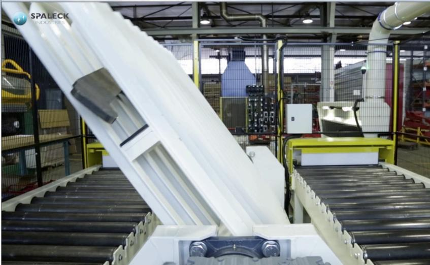
Dans certains cas, il est préférable d'optimiser le poste de meulage plutôt que tout automatiser. L'installation présentée propose deux postes d'ébavurage pouvant être équipés d'un bras de meulage, et un retourneur de pièces.
