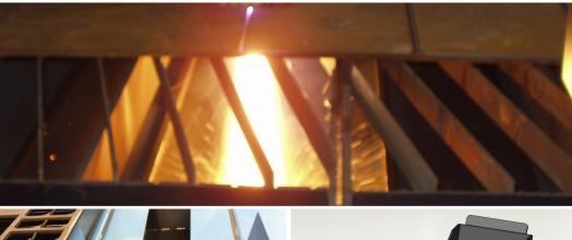
Le chariot se positionne sous les buses de découpe pour capter les fumées et récupérer petites pièces et scories dans son bac amovible.
